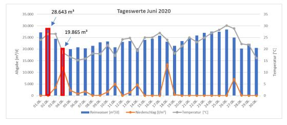
Die Differenz an den beiden markierten Tagen beträgt 8.778 m³. Es wird ca. 44 % mehr Trinkwasser in Trockenperioden abgegeben als an Tagen mit Niederschlag.
